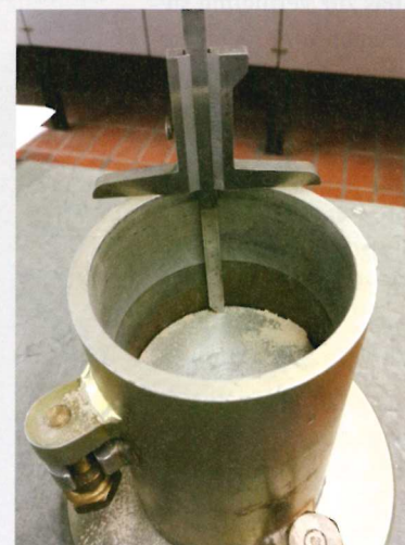
Bild 7: Ermittlung des Volumens der verdichteten Gesteinsprobe
