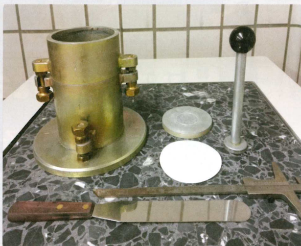
Bild 6: Werkzeuge zur Ermittlung der Rütteldichte nach Rubach, Proctortopf, Abdeckplatte, Filterpapier, Magnet, Tiefenlehre und Spachtel
