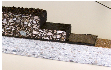
Querschnitt Abdichtung DIN 18532 Teil 2
